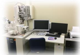
担当機器 電界放出形走査電子顕微鏡 (日立ハイテク SU8230/EDS/EBSD)
